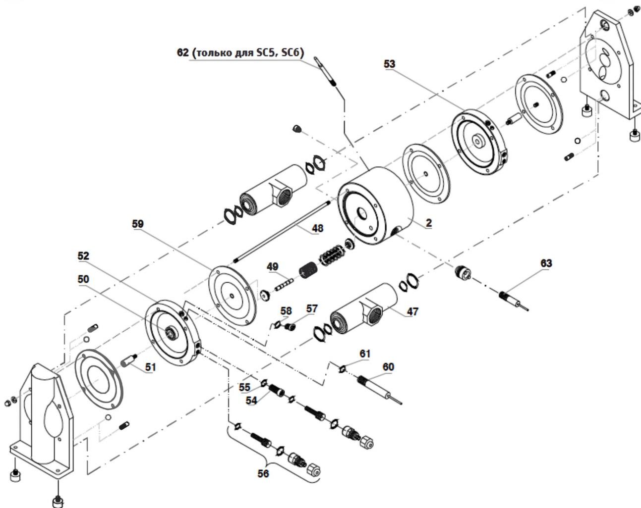
Система барьерных камер для DM 20, DM 25, DM 40, DM 50
